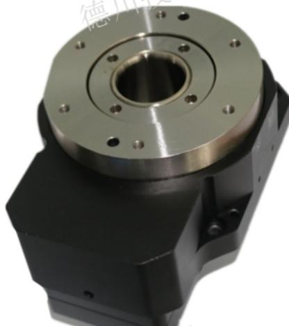
安装中空旋转平台有哪些注意事项？中空旋转平台厂家德川技研将一一为大家解答。如何安装中空旋转平台在机器安装板上留出马达出口，以合露出马达。利用2个定位销孔（GSB60/GSN60中定位销孔与安装孔是共用的），将中空旋转平台安装到下图所示的机器安装板上。这些安装孔用于在机器上准确定位中空旋转平台，务必将定位销孔牢固固定在安装板上。如何在中空旋转平台上安装负载使用中空旋转平台上的6外安装螺孔安装负载。中空旋转平台上有2个安装负载用的销孔，可用于确定负载的位置，务必将定位销牢固固定在负载上。安装中空旋转平台的注意事项安装之前，应通读如下安装注意事项，并按如下条件安装中空旋转平台减速机。1、应该安装在室内（不直接接触阳光的区域）2、没有热辐射的区域3、工作环境温度：0-50度4、原点传感器下方温度：0-42度5、工作环境温度：低于85%6、不存在易燃易爆的酸性气体7、可阻挡灰尘。油和溅水的地方8、不遭受直接震动和过度撞击的地方。
