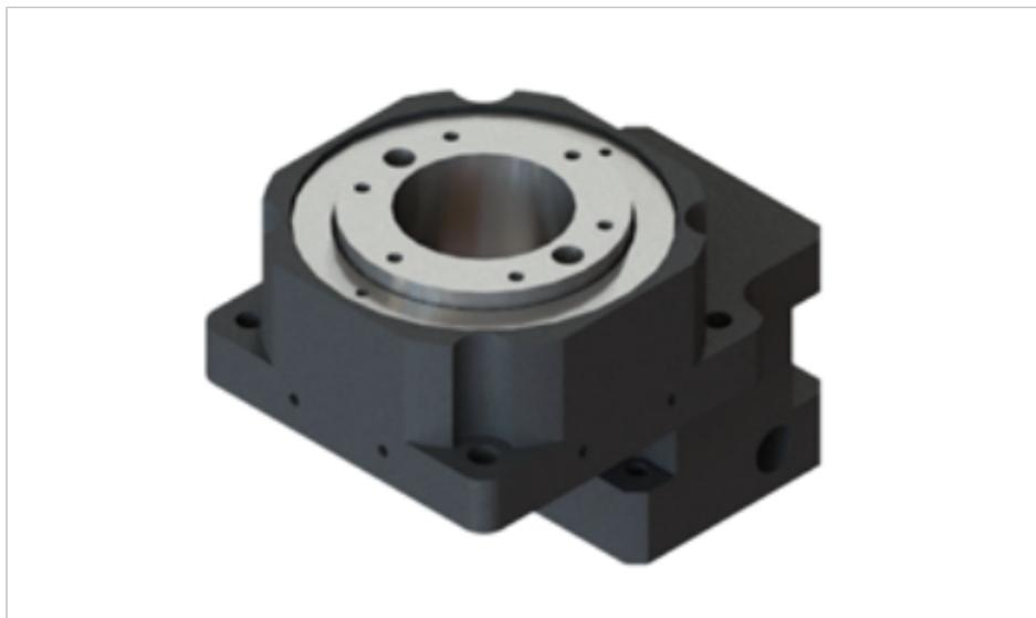
中空旋转平台是什么-全新的旋转负载装置旋转平台出现缘由：机械动作包含直线运动和圆周运动，直线运动以各类型滑台为\*\*，而圆周运动则以分割器具代表性，之后因技术的成熟及设备对精度的要求，进而产生了DD马达。然而，传统分割器无法满足任意分割的需求；而DD马达虽能多元化应用，精度高，但它的价格成本却成为使用者的一大门槛。“旋转平台”的出现在两者之间取得平衡，重复定位精度≤5秒，不仅能大幅度降低DD马达的成本，更能满足分割器所无法提供的高精度及数位化控制。旋转平台分类：（1）同轴输出型：电机连接方向与转盘同轴；（2）旁轴输出型：电机连接方向在转盘侧边；转盘为中空结构，可穿线；（3）直角输出型：电机连接方向与转盘中心方向呈90度；转盘为中空结构，可穿线；中空旋转平台中空旋转平台是什么-全新的旋转负载装置性能特点：1. 一体化不锈钢本体确保大刚性与耐蚀性，多重精密加工表面易于组装。2. 采用蜗线伞齿轮的设计软体，经佳优化设计接触齿面负载均一容许高扭矩输出，齿轮采\*\*力渗碳合金钢，研磨精密度符合DIN5级标准以内。3. 多重不锈钢输出入力轴的设计可以适用于各种工业上应用的需求。
